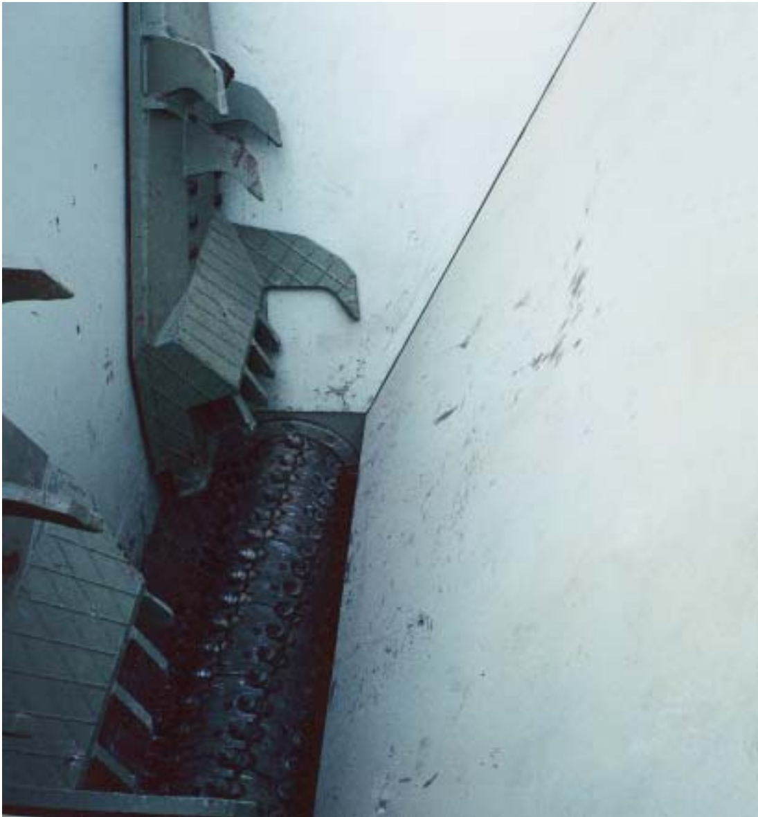
Bild 6: Aufgabetrichter einer Brecheranlage, Wände aus DILLIDUR 400 V
