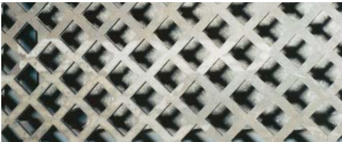
Bild 18: Lasergeschnittenes Siebblech aus DILLIDUR 400 V, Blechdicke 12 mm
