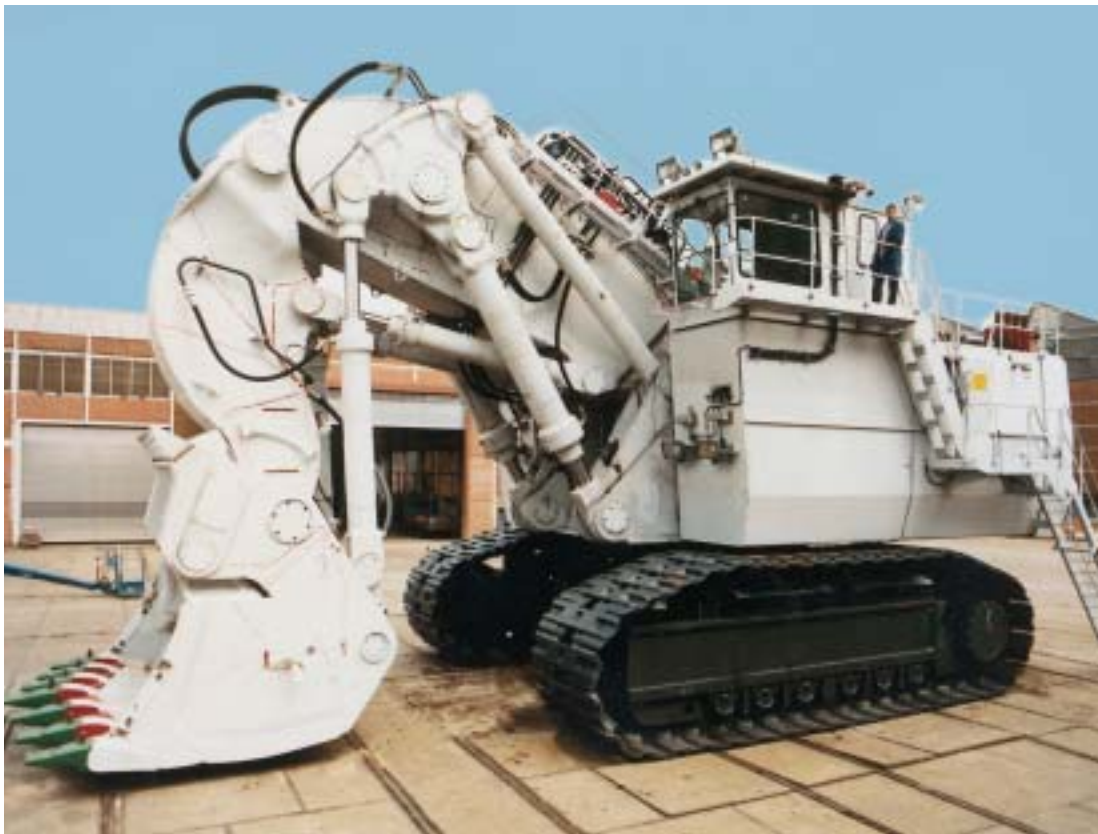
Bild 4: O&K-Hydraulikbagger RH 400: Tragende Bauteile aus DILLIMAX 690 T (Bild mit freundlicher Genehmigung der Orenstein & Koppel AG, Dortmund)
