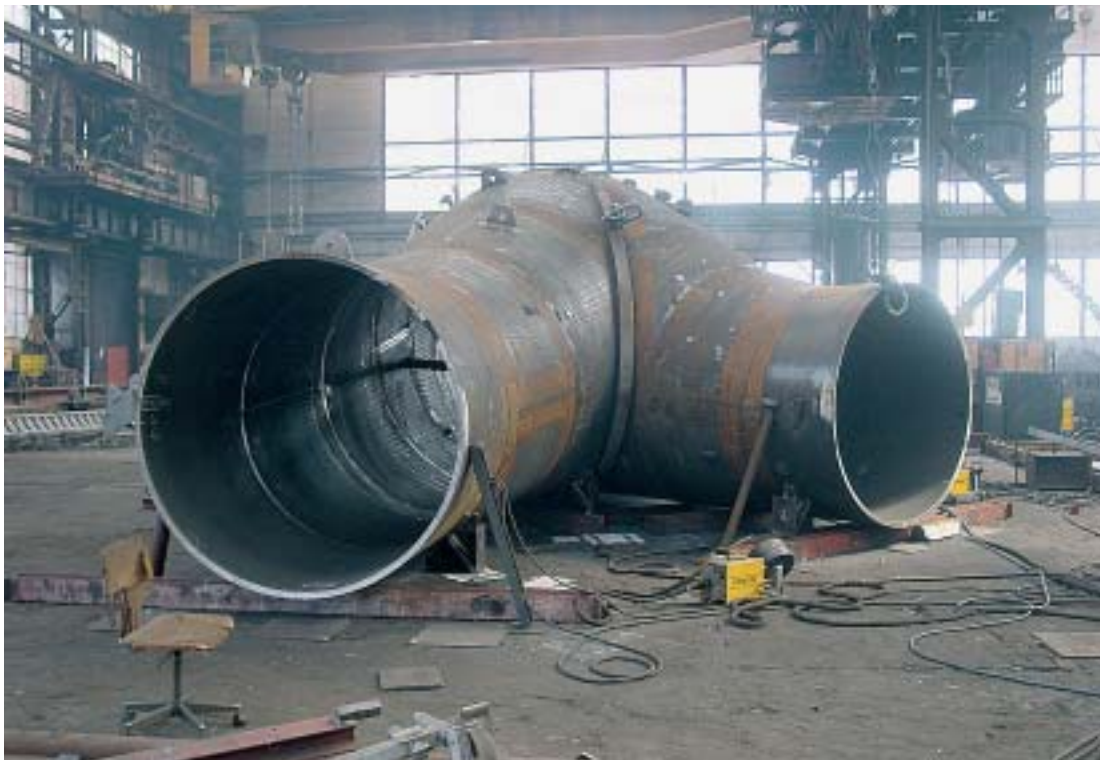
Bild 6: Rohrschüsse aus DILLIMAX 690 für die Fallrohrleitungen des Wasserkraftwerkes Kárahnjúkar (Bild mit freundlicher Genehmigung der Firma DSD Noell GmbH, Würzburg, Deutschland)
